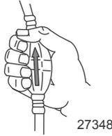
**ВАЖНАЯ ИНФОРМАЦИЯ:** Для предотвращения перелива топлива двигателя не сжимайте грушу заправочного насоса после прогрева двигателя.
