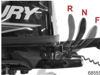
**ПРИМЕЧАНИЕ:** Двигатель не запустится, если шнур не соединен с выключателем останова.
